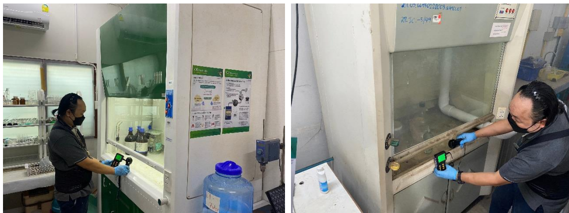
ภาพที่ 2 การตรวจสอบและทดสอบประสิทธิภาพตู้ดูดควันภายในภาควิชา
